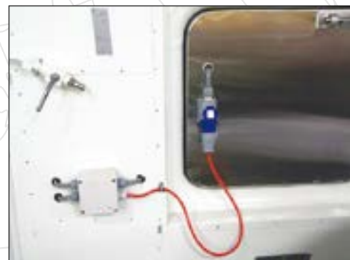
ЛЮКИ Линия обогрева необходима для предотвращения обледенения в уплотнениях люка, чтобы он мог открываться так, как положено.
