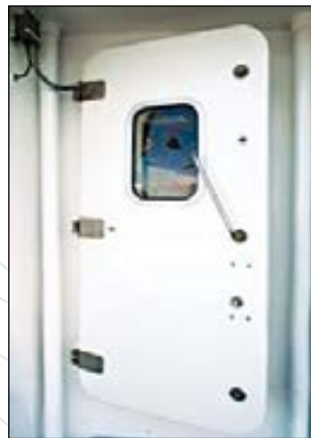
УПЛОТНЕНИЯ ДВЕРЕЙ Для водонепроницаемых дверей требуется значительное количество тепла для предотвращения обледенения уплотнений.
